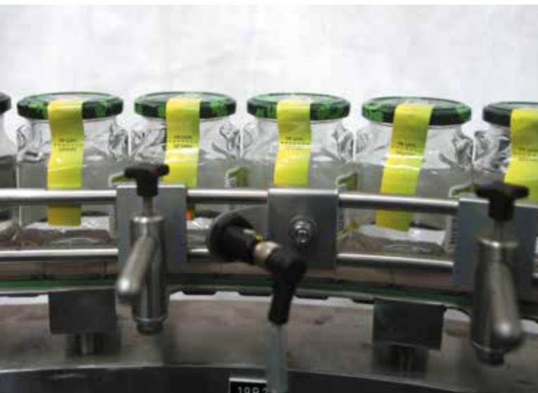
L'étiquetage d'inviolabilité est disponible avec un étiquetage enveloppant complet ou partiel et un étiquetage frontal et dorsal, avec orientation, à la fois pour le conteneur et les étiquettes - le tout avec une seule machine !
